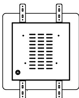
**ES** Instale la luminaria en la posición deseada, atornillándola al accesorio de sujeción en donde vaya a ir colocada por los orificios que se encuentran en la lira.
