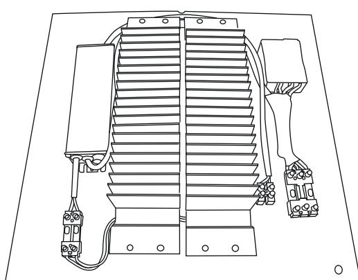
**ES** Fácil acceso a los componentes eléctricos con conectores rápidos que permiten hacer modificaciones o reparaciones de forma sencilla sin necesidad de desmontar la luminaria. Consultar manual de montaje de NTE para saber las herramientas necesarias.
