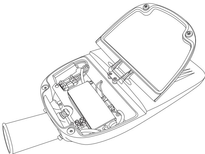
**ES** Fácil acceso a los componentes eléctricos con conectores rápidos que permiten hacer modificaciones o reparaciones de forma sencilla sin necesidad de desmontar la luminaria. Consultar manual de montaje de NTE para saber las herramientas necesarias.
